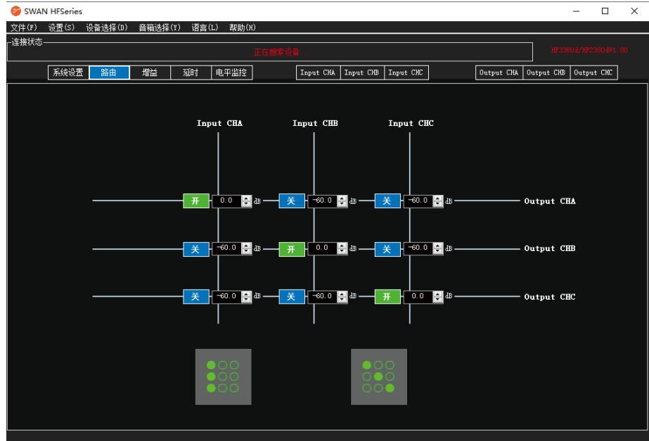
路由选择(有两种固定的路由方式，如果使用本机DSP，请选择一进三出的路由方式。如果使用外搭DSP，请选择三进三出的路由方式)
